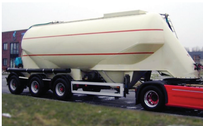
Εικ. 51 . Βυτία-σιλό για στερεές ύλες σε μορφή σκόνης ή κόκκων.
