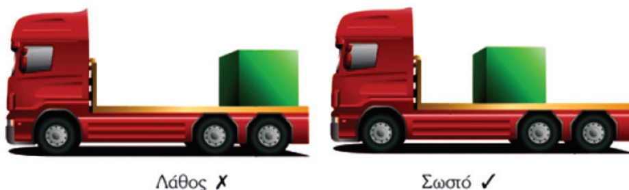
Εικ. 38 Κατά μήκος της πλατφόρμας τοποθέτηση φορτίου.
